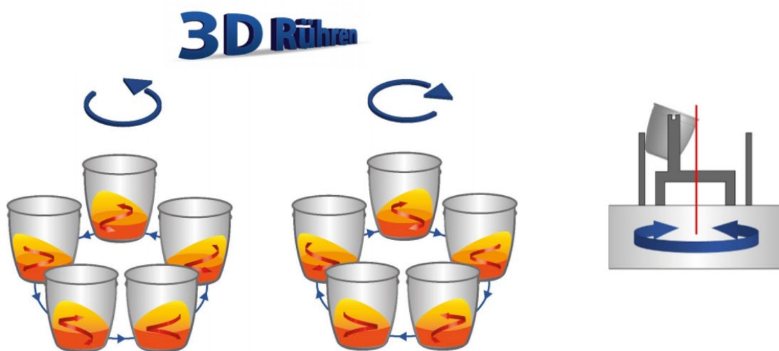
Abbildung 4: Anwendung des Rotationsrührprinzips beim VITRIOX® ELECTRIC im Tiegel
