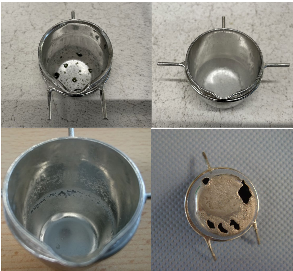
Abbildung 1: verschiedene Arten von Schäden an den Tiegeln
