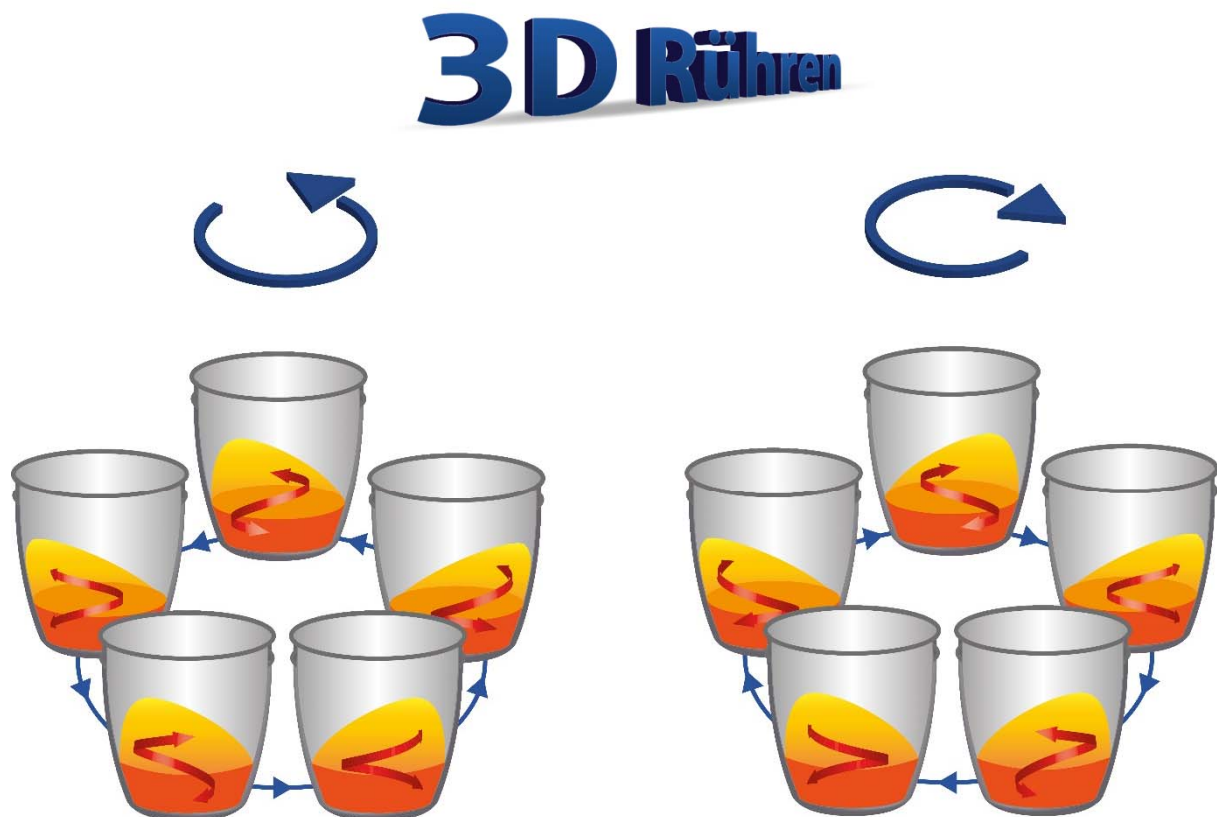
Abb. 1: Die Abbildung zeigt das Prinzip des kreisförmigen 3D Rührens der VITRIOX Geräte.
