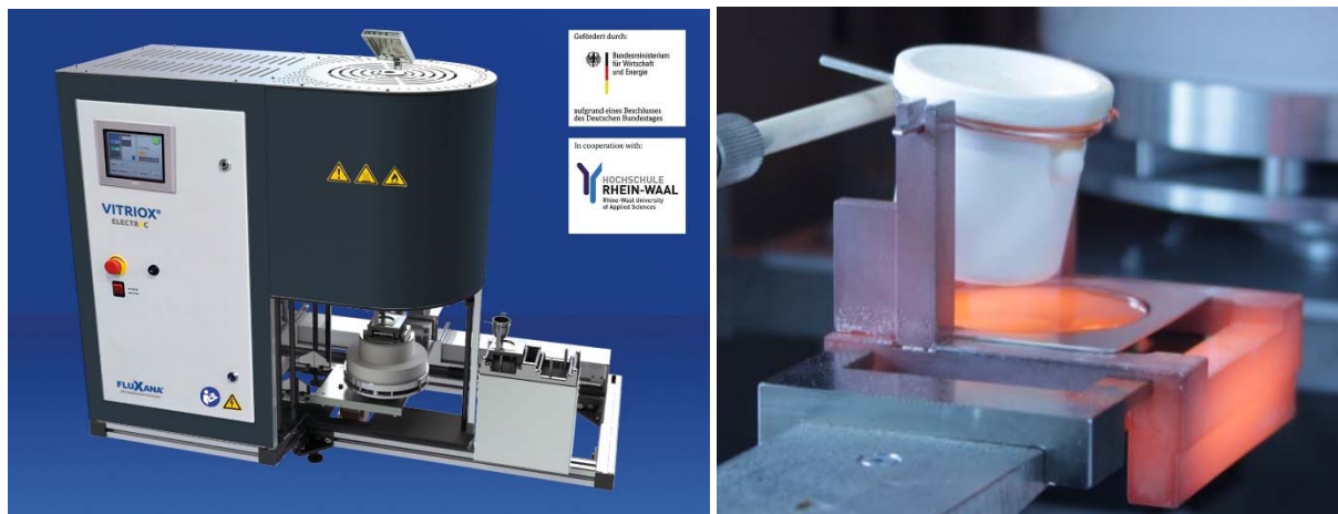
Abb. 1 Elektrisches Schmelzgerät mit 2 Stationen, Quarztiegel in der Anwendung.
