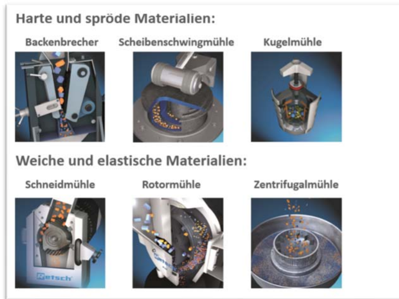
Abbildung 2 Prinzip: Zerkleinern einer Probe
